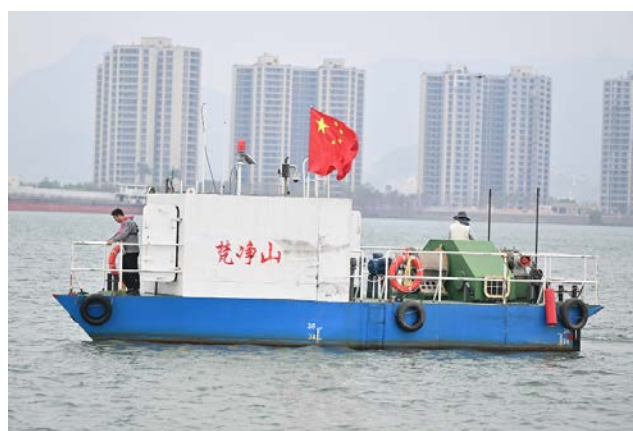
20kW发电样机河面航行测试
